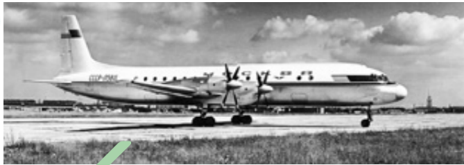
Первый опытный турбовинтовой пассажирский самолет Ил-18 под именем «Москва» с двигателями НК-4 подняли в воздух 4 июля 1957 г.
